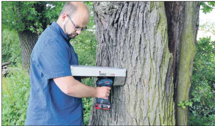
Gesundheitscheck für einen Baum mit einem Bohrwiderstandsmessgerät. André Matzke führte es praktisch vor.
